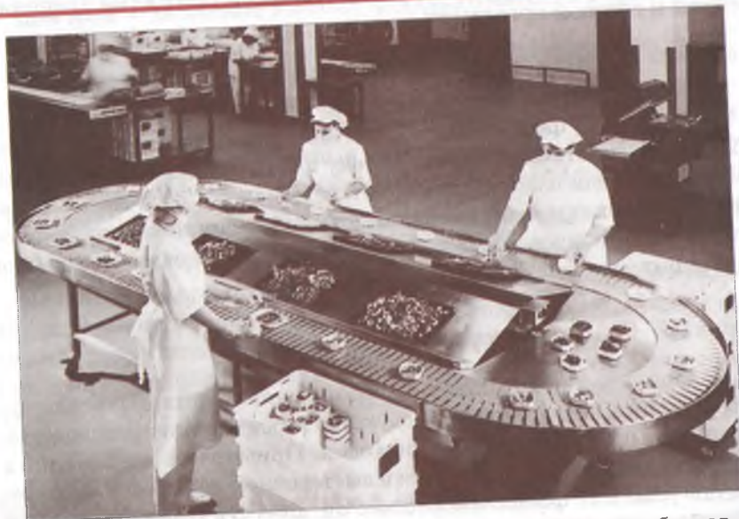
Рис. 1.3. Поточная линия по комплектации и упаковке ланч-боксов на фабрике бортового питания «Истлайн Домодедово Эйр Сервис»
